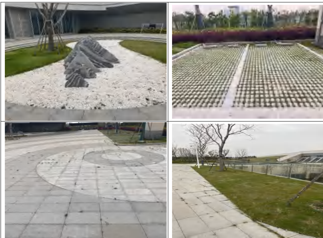
透水铺装及园林绿化照片（近景）2022.6.15
